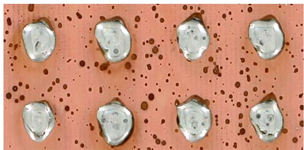
*Flussmittelspritzer konventioneller Lötdraht*
